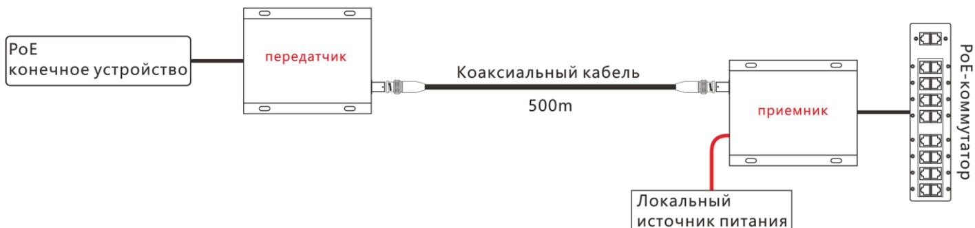
2. Когда приемное устройство питается от PoE-коммутатора, как передающее устройство, так и устройства PoE получают питание без необходимости во внешнем источнике питания.
