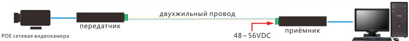
1. При подаче приёмнику электроэнергии от 48~56VDC , передатчик и POE устройство могут получать питание, не потребуется внешнего питания.
