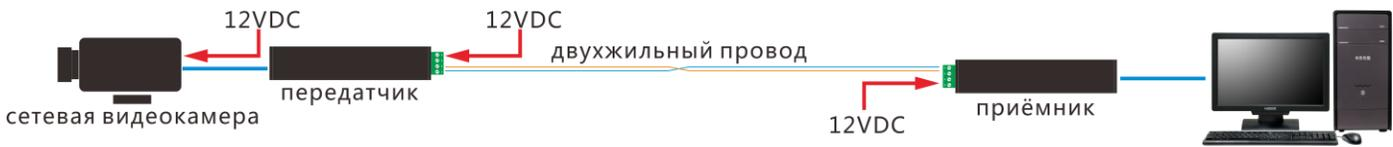
Внимание: Не поддерживает ввод модуля PoE питания, в том числе PoE коммутатор, PoE Регистраторы с жестким диском. Только принят ввод питания в пределах 48~56VDC. При передаче PoE, в ходе передачи выхода питания наблюдается потеря, а это зависит от размера кабеля, например, действующее расстояние передачи кабеля в виде RVV2x0.75mm<sup>2</sup> почти до 300 метров.
