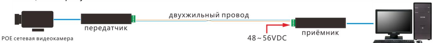
2. При подаче приёмнику питание 12VDC, передатчику не можно получить PoE питание. В этом случае передатчик нужен передним сетевым устройством соответственно подключить к питанию в пределах 12VDC
