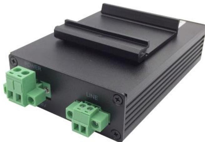
单口导轨式网络传输器为高速以太网信号传输设备。使用它可将网络信号通过任意两芯线，如双绞线、电话线、同轴线、电源线等电缆进行长距离传输，传输距离可达 600 米，最大物理速率可以达到 500Mbps。
